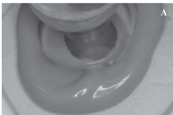
Figura 3 – Molde de silicóna de adição (A) e corte longitudinal do molde (B)
