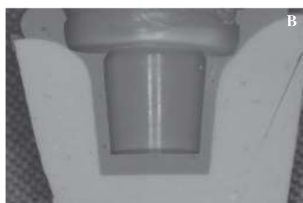
Figura 3 – Molde de silicóna de adição (A) e corte longitudinal do molde (B)
