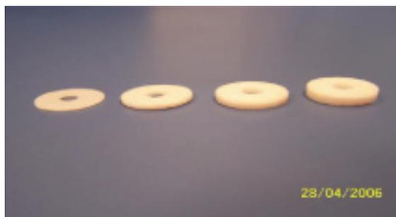
**Figura 1** - Matrizes em teflon nas espessuras de 1, 2, 3 e 4mm
