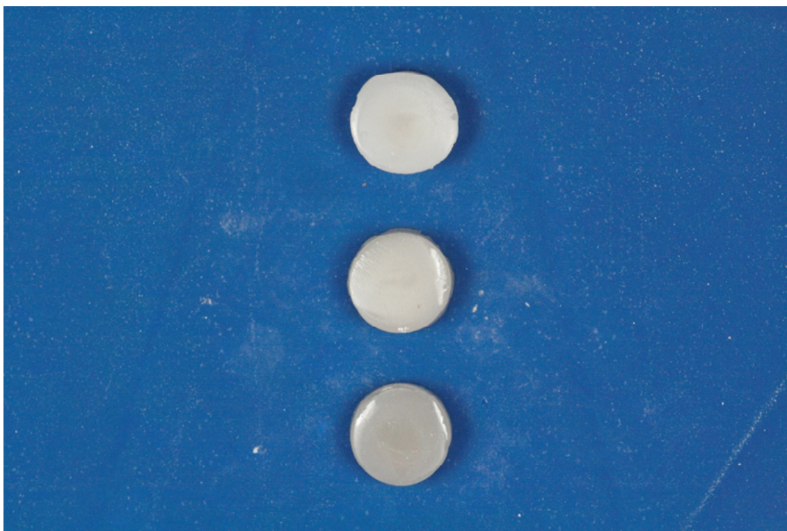
Figura 2 - Imagem obtida pela máquina fotográfica digital na câmara escura, a ser utilizada na mensuração de cor da superfície das amostras.
