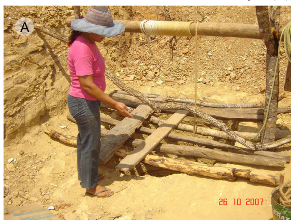
Fotografia 3 – Extração manual de quartzo em sistema de cavas (A) rejeito disposto na área sem nenhuma medida de contenção (B)
