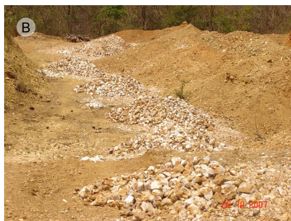
Fotografia 7 – Remoção da vegetação em área de extração de cascalho (A). Remoção da vegetação para extração e empilhamento do quartzo (B)
