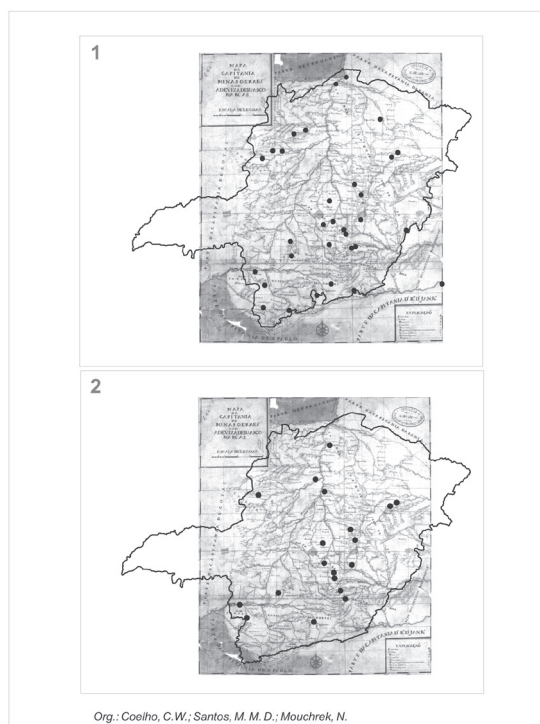
FIGURA 5 – Georreferenciamento a partir do procedimento de determinação de coordenadas geográficas: O alinhamento do mapa histórico ao atual é mais satisfatório em 2 , realizado com um menor número de pontos de controle, mas mais precisos, do que se mostra em 1 .
