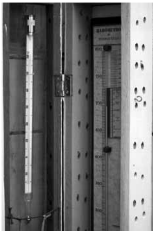
Figura 01 Detalhes do instrumental utilizado. Em "a", porção superior do barômetro. Em "b", porção inferior do barômetro, destacando o depósito de mercúrio. Em "c", detalhe da escala e em "d", visão do conjunto. Em "e", visão geral dos psicrômetros.
