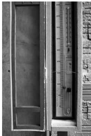
Figura 01 Detalhes do instrumental utilizado. Em "a", porção superior do barômetro. Em "b", porção inferior do barômetro, destacando o depósito de mercúrio. Em "c", detalhe da escala e em "d", visão do conjunto. Em "e", visão geral dos psicrômetros.
