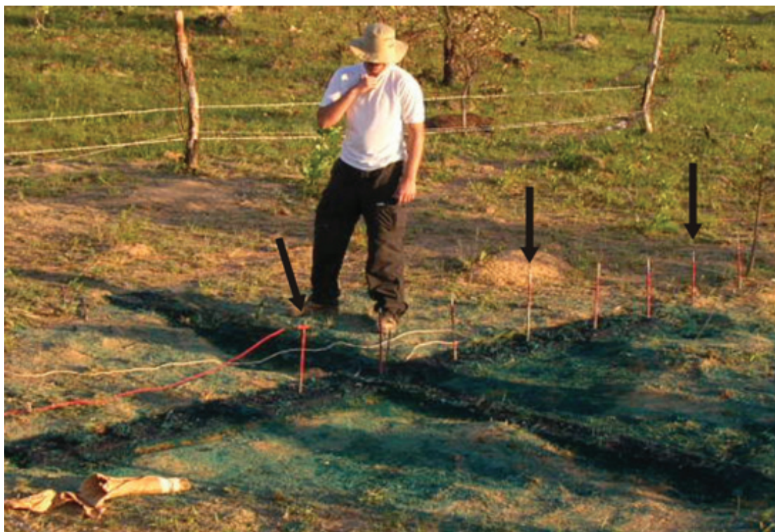
Figura 3 Medida de eletrorresistividade realizada após a injeção da solução traçadora; as setas indicam os eletrodos.
