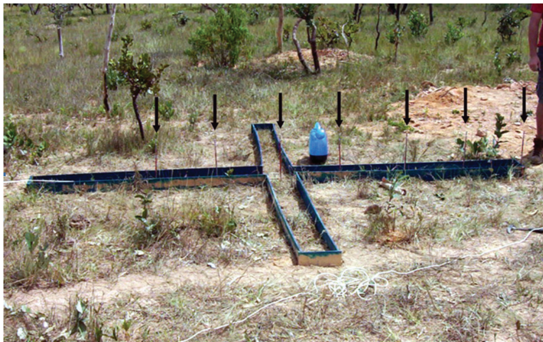
Figura 2 Disposição dos eletrodos dentro da caixa delimitadora da área a receber a solução aquosa (levantamento base). As setas indicam os eletrodos fincados no solo.
