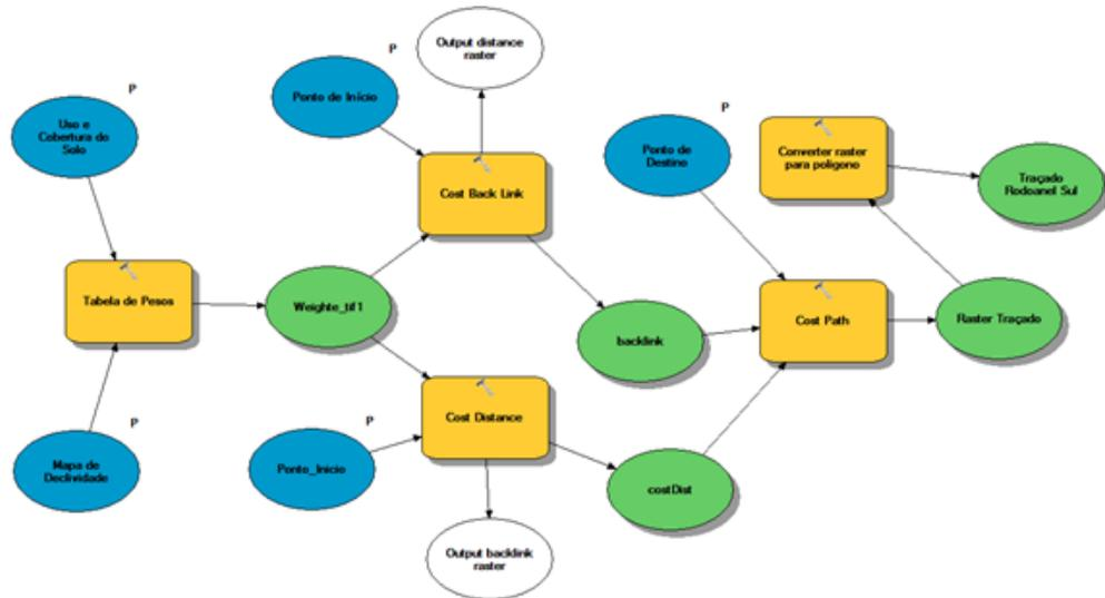
Figura 4: Modelo baseado em análise multicritério, construído através da ferramenta Model Builder do software ArcGis 10.1
