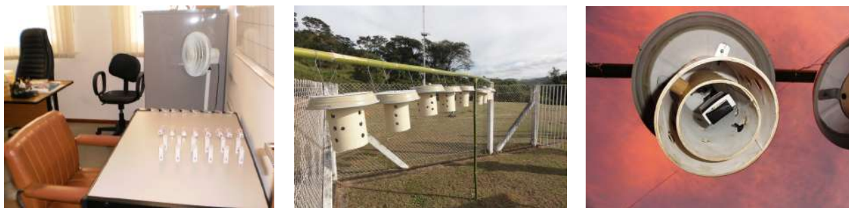
Figura 6 Aferição dos termohigrômetros dataloggers Hobo em ambiente fechado e na Estação Meteorológica da UFV, juntamente com os abrigos meteorológicos alternativos, fixados a 1,5 metros de altura.
