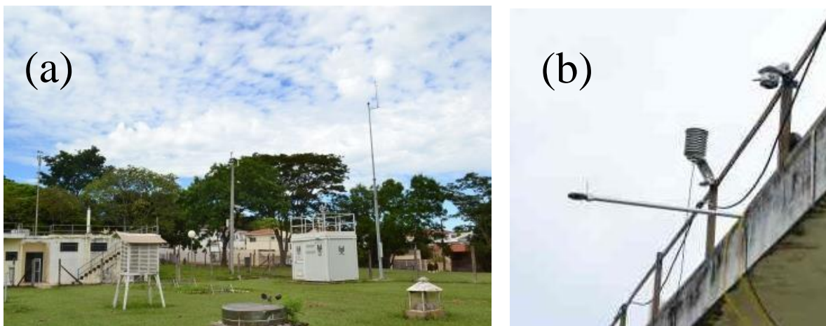
Figura 3. Estação meteorológica na FCT/UNESP (a), saldo-radiômetro, pirgeômetro e termohigrômetro (b) instalados e operando.
