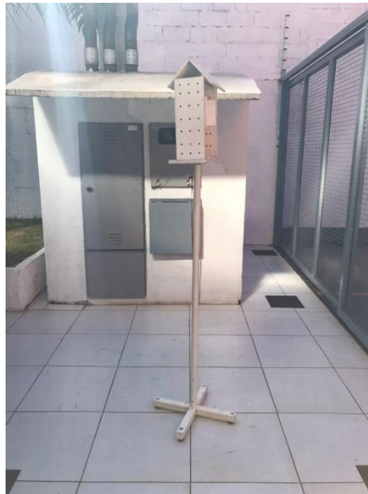
Figura 3. Abrigo meteorológico do experimento de campo
