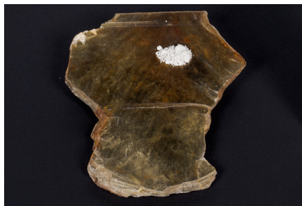
Figura 21 – Fotografia de fragmento e pó de Mica de cor branca. Autor: Marcos Gohn, setembro/2012.
