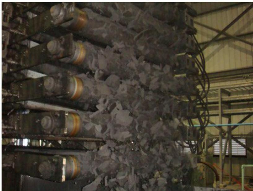
Figura 4 – Filtros – Vertical a Vácuo e Prensa
