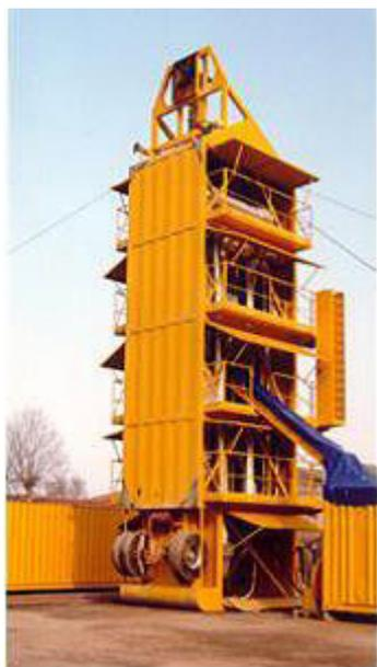
Figura 1 – Calcinador Flash Demeter Technologies
