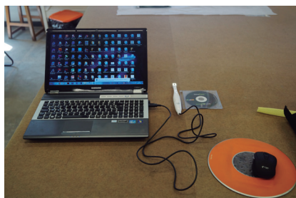
FIGURA 8: Equipamento INTRACAM para exame de microscopia. Foto: Agesilau Almada, 2013.
