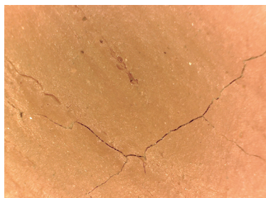
FIGURA 7: Fissuras vistas com microscopia USB. Foto: Agesilau Almada, 2013.
