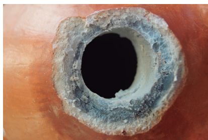
FIGURA 44: Resíduos de PVA localizados no fragmento do corpo da moringa, após a separação das partes. Foto: Agesilau Neiva Almada, 2013.
