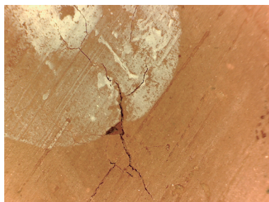
FIGURA 27: Detalhe de microfissura sob a camada de policromia da peça. Foto realizada com microscopia USB, aumento de 60x, Agesilau Neiva Almada, 2013.
