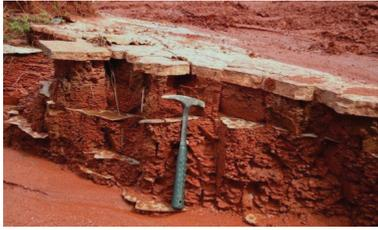
Foto 3 – Camada de arenito sobre siltitos microfraturados, estes facilmente removidos pela erosão.
