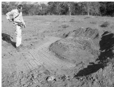
FOTO 43 – Escavação expondo arenito fraturado sob a camada de siltito
