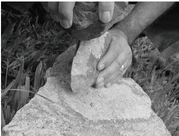
Apoio sobre bigorna (preparação de lâmina de machado)
