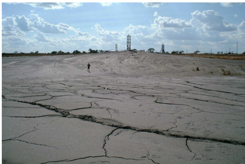
Figura 9 – Deposição de Pasta - Sistema de Torres de Deposição Fonte: FLSmidth (Dorr-Oliver Eimco)
