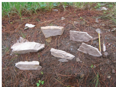
Figura 3. Diferencias cromáticas y texturales en lajas rústicas producidas en dos segmentos de la cantera del Barrio San Antonio Norte – Duitama. (A) Lajas de arenitas de cuarzo de color rosado claro, con laminación interna ondulada paralela y escasa matriz arcillosa. (B) Lajas de segmento de arenitas de cuarzo y líticos de color gris oscuro con tonalidades rojizas, con niveles de materia orgánica y fuerte oxidación.
