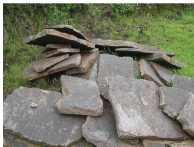
Figura 3. Diferencias cromáticas y texturales en lajas rústicas producidas en dos segmentos de la cantera del Barrio San Antonio Norte – Duitama. (A) Lajas de arenitas de cuarzo de color rosado claro, con laminación interna ondulada paralela y escasa matriz arcillosa. (B) Lajas de segmento de arenitas de cuarzo y líticos de color gris oscuro con tonalidades rojizas, con niveles de materia orgánica y fuerte oxidación.
