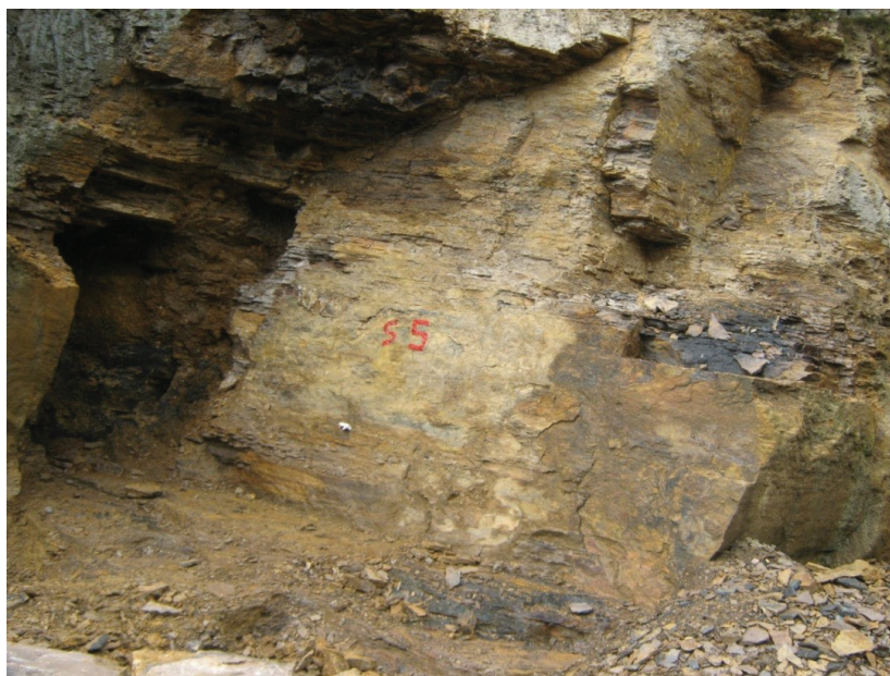
Figura 7. Segmento 5 del Banco de Producción No 3, mostrando la disposición de los estratos en forma subhorizontal (línea roja) con espesores de arranque aprovechables y las fracturas que limitan el tamaño de los bloques (línea amarilla).
