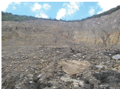
Figura 2. (A) Explotación de lascas rústicas de arenitas de la Formación Une en el barrio San Antonio Norte (Duitama) con producción de gran volumen de residuos. (B) Proceso de remoción en masa debido a la actividad minera indiscriminada en la vía Duitama – Santa Rosa de Viterbo.
