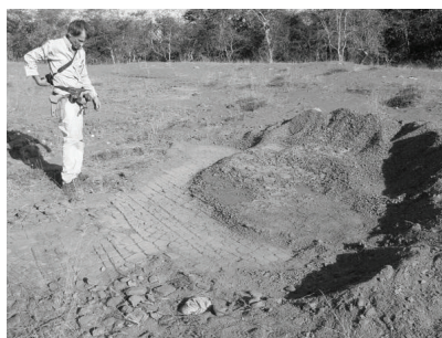
FOTO 43 – Escavação expondo arenito fraturado sob a camada de silito
