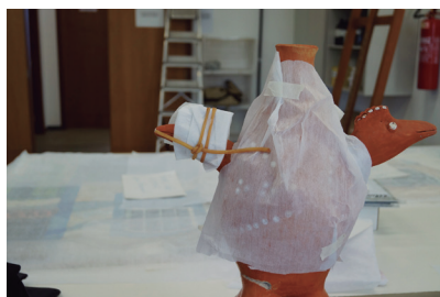
FIGURA 53: União dos fragmentos da crista da ave direita. Região sob pressão, com ligas elásticas, para a adesão das partes. Foto: Agesilau Neiva Almada, 2013.
