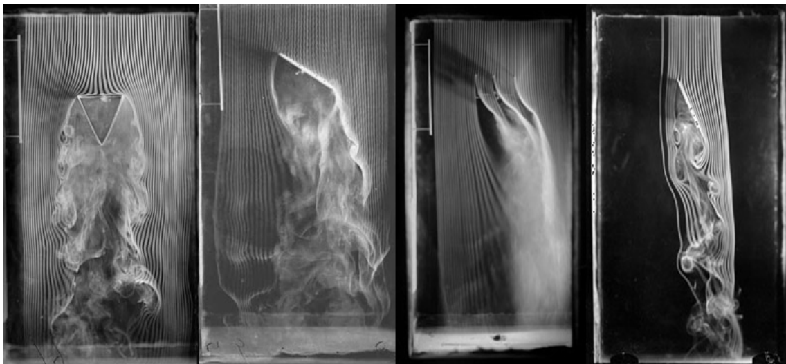
Fig. 01. Etienne-Jules Marey, Prisma triangular apresentando uma das suas bases à corrente de ar , quarta e última versão da máquina de fumaça equipada com 57 canais (1901) Paris: Cinémathèque française
