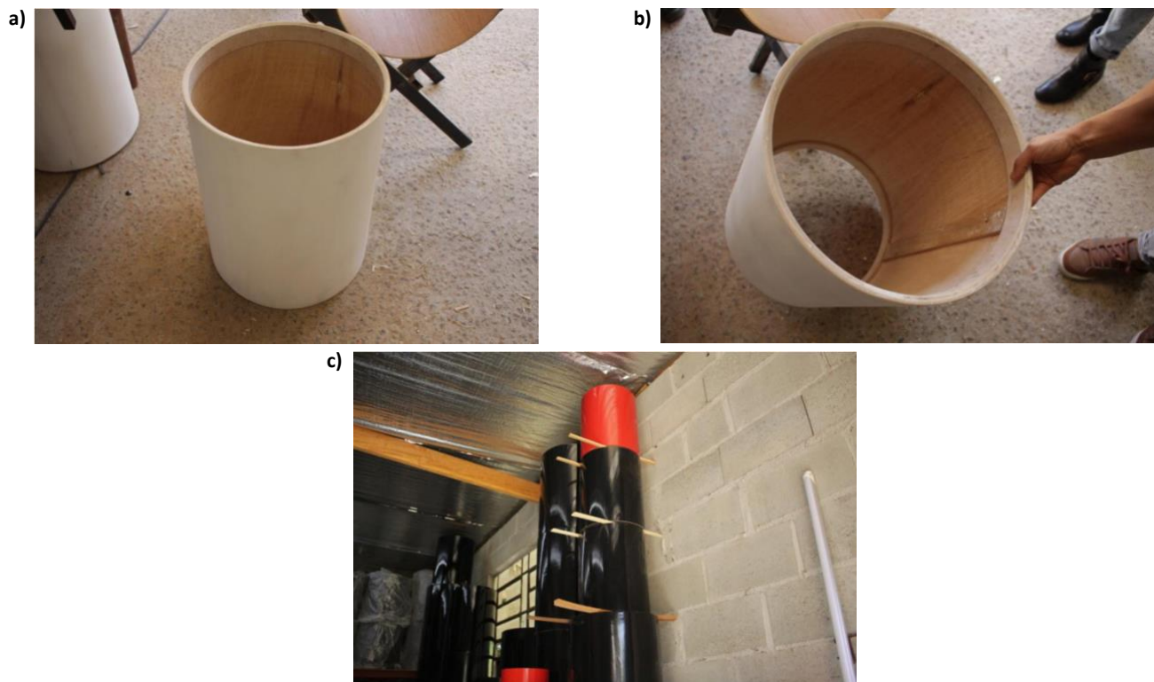
Figura 16 – Acabamento do cilindro: a) detalhe da emenda e da boca, b) cilindro com a massa para madeira, c) cilindros finalizados Fonte: Arquivo pessoal do autor
