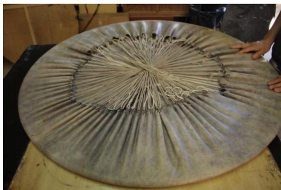
Figura 18 – Couro sendo tensionado sobre o aro de ferro Fonte: Arquivo pessoal do autor
