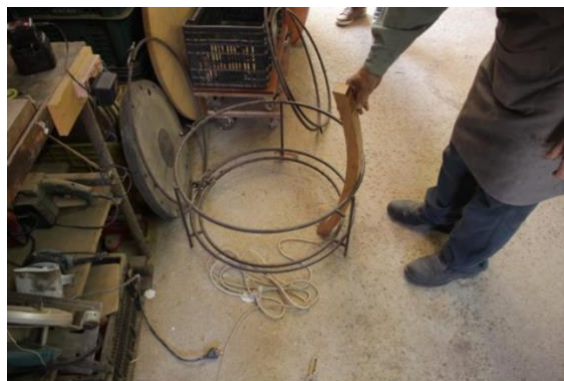
Figura 9 – Forma utilizada para prensar os "gomos" no processo de colagem Fonte: Arquivo pessoal do autor
