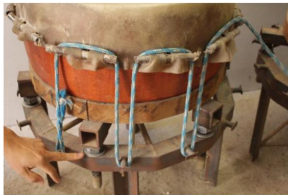
Figura 13 – Couro sendo esticado na máquina Fonte: Arquivo pessoal do autor
