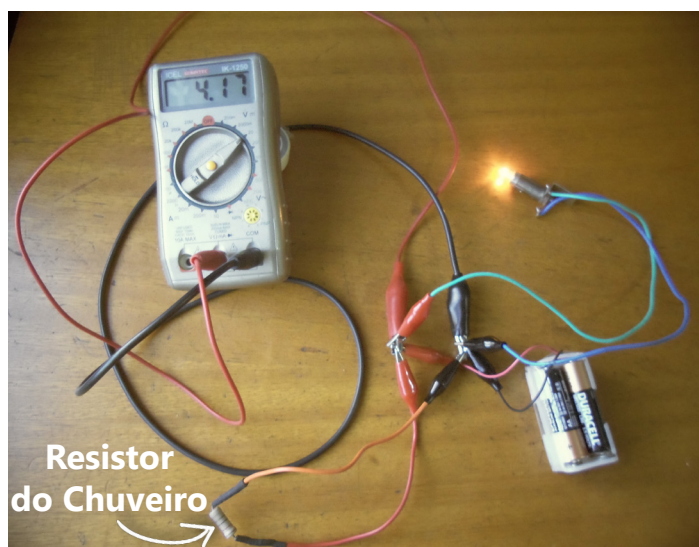
Figura 4. Versão final do experimento com pilhas, lâmpada e resistor do chuveiro
