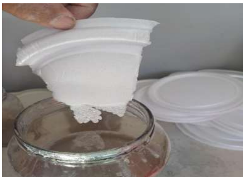
Figura 03: Tampa da marmitta em estado de diluição
