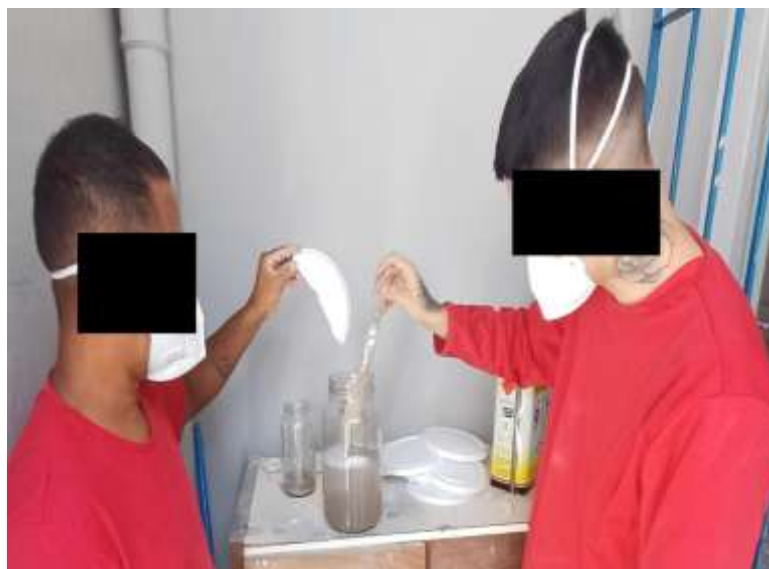
Figura 02: Processo de diluição do Poliuretano no Thinner PU
