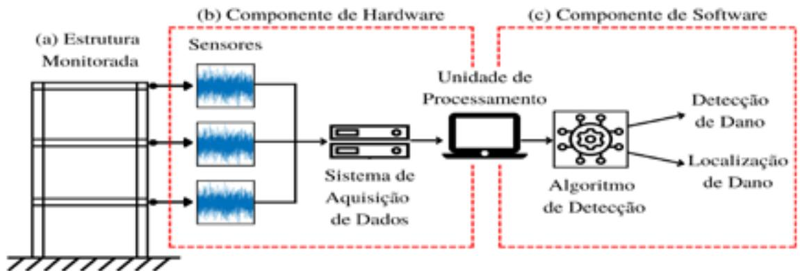
Figura 1 – Principais elementos de sistemas de detecção de danos estruturais.
