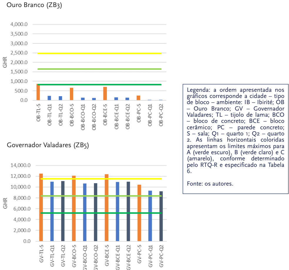
Figura 4 - Gráficos de Graus-hora para resfriamento para os diferentes sistemas construtivos na cor branca nas paredes externas ( \alpha = 0,3 ) para as cidades de Ibirité, Ouro Branco e Governador Valadares.
