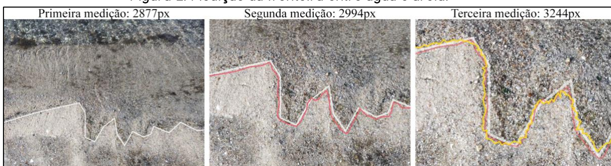
Figura 1: Medição da fronteira entre água e areia.
