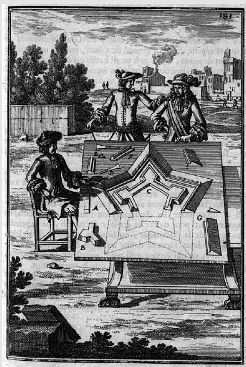
Figura 12. Manera de representar con madera un relieve, en la obra de Manesson-Mallet (1684: 181).
