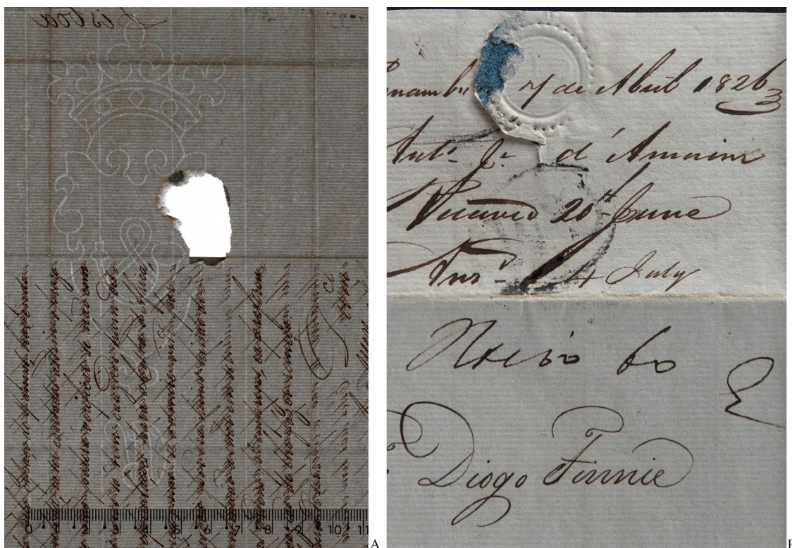
Fig. 2. – A: Registro da marca-d'água e das vergaturas e pontusais com iluminação transmitida. B: Detalhe das marcas em relevo e resíduo do lacre no espaço de endereçamento da carta, selo com as letras "CM" invertidas, e marca de dobra e perda pontual de papel na região, com acúmulo de tinta ferrogálica na letra J. Fotos: Juliana Bittencourt/LACAPC/IF-USP.
