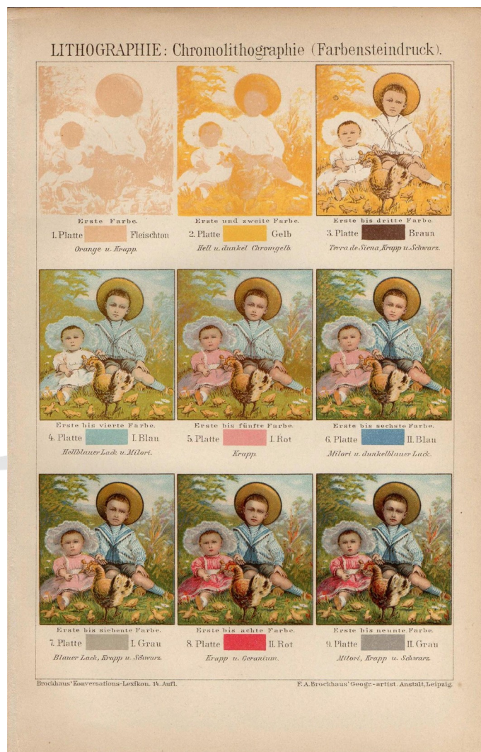
Fig. 5 – Prova de cor progressiva exemplificando o processo de uma cromolitografia de nove cores, publicada na enciclopédia Brockhaus, 14. ed., v. 11, Leipzig, 1894. A prova progressiva é um instrumento de teste e de registro das cores das tintas isoladas e de como operam em conjunto no resultado cumulativo de sobreimpressão das matrizes, servindo também como um guia de conferência para o impressor dos resultados intermediários ao longo da tiragem.
