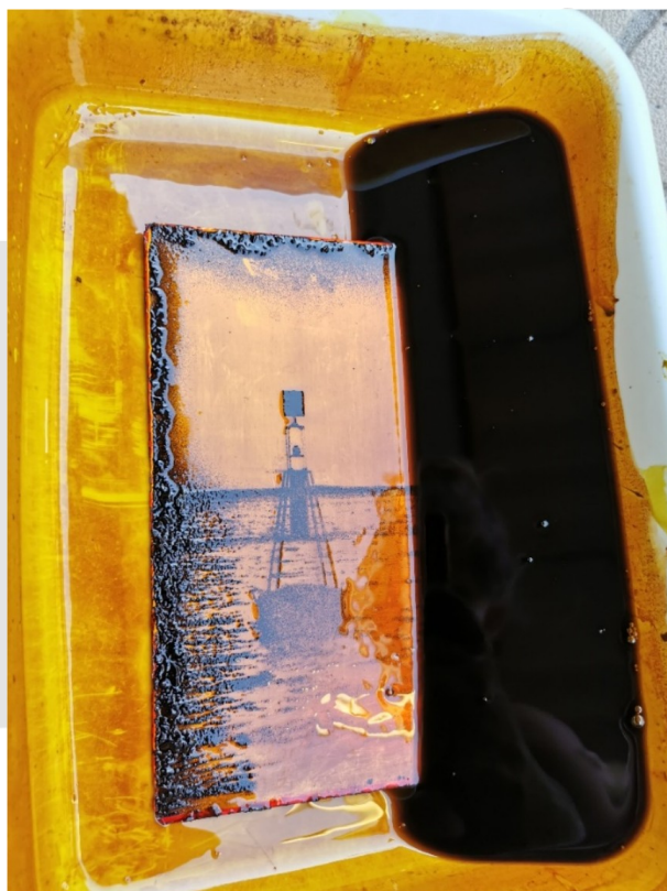
Figura 2. Processo de gravação com percloroeto com a corrosão em evidência. Fonte: IDZI, 2023, p. 105.
