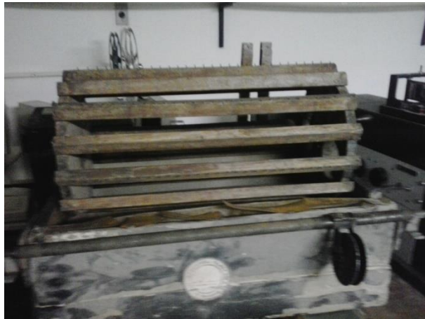
Figura 1 – Tanque de revelação de películas confeccionado por Igino Bonfioli
