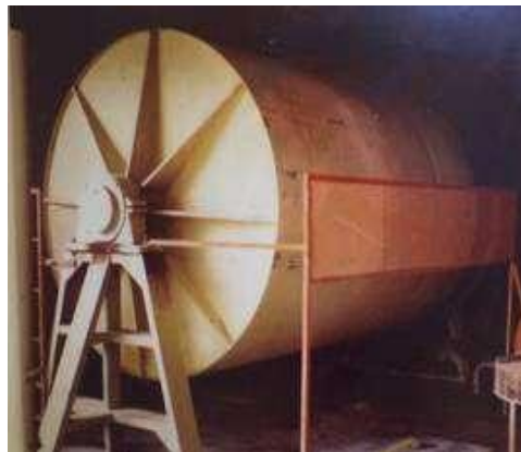
Imagem 08: “Tamborão” utilizado pela Cerâmicas Santana para a mistura da massa da porcelana. Década de 1980. Acervo Museu Histórico e da Porcelana de Pedreira.
