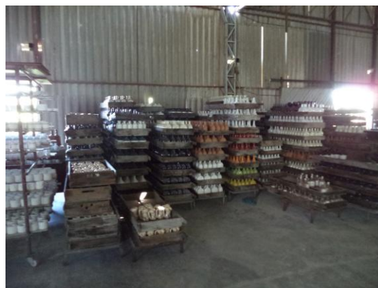
Imagem 14: Armazenamento de peças da empresa Cerâmicas São Joaquim. Observa, no canto inferior esquerdo, a utilização de estantes com rodas para facilitar o transporte das peças. Foto: Raul Lanari, 24/01/2014
