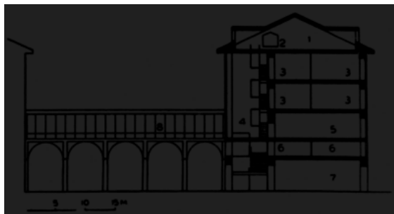
Figura 2: Secção esquemática do Falanstério: (1) sótão com os quartos para os hóspedes, (2) reservatórios hídricos, (3) aposentos privados, (4) rue intérieure, (5) salas de reunião, (6) sobreloja, (7) andar térreo com passagens para viaturas, (8) passadiço coberto.
