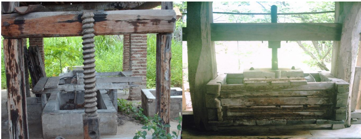
Fig. 5 – Prensas com fuso de madeira à esquerda e com fuso de ferro à direita. Casas de farinha modificadas na década de 1970 com a introdução de ferramentas mais eficientes. Foto de 2005. Fotos digitalizadas. Acervo: Evandro de Araújo. Estas prensas se encontram nas localidades de Bico da Arara e Nova Olinda, respectivamente.
