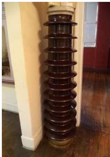
Imagem 04: Bobina de cerâmica para linhas de transmissão de energia elétrica. Acervo Museu Histórico e da Porcelana de Pedreira/SP. Foto: Raul Lanari, 23/06/2014
