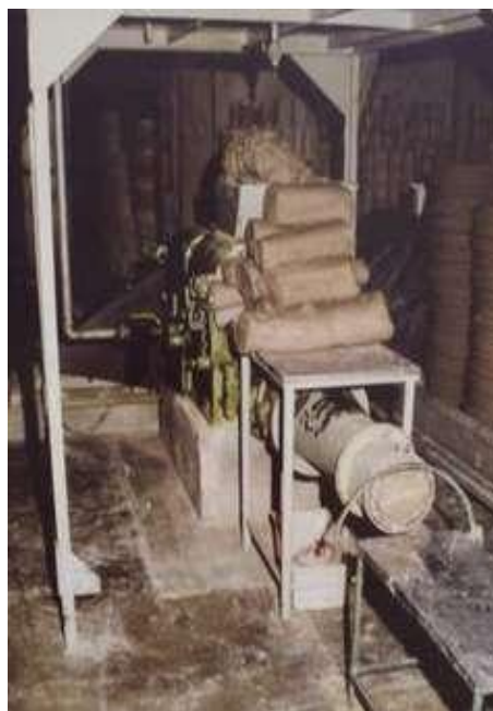
Imagem 10: Processo de extrusão da borbotina com a utilização do equipamento conhecido como “Maromba”. Cerâmicas Santana, década de 1980. Acervo Museu Histórico e da Porcelana de Pedreira.
