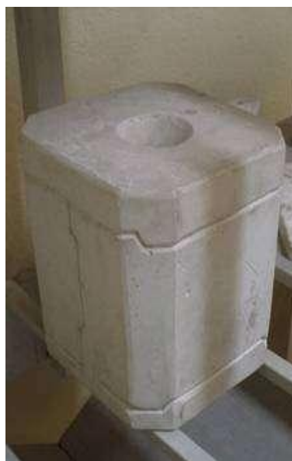
Imagem 12: Molde utilizado para a fabricação de vasos de porcelana. Acervo Museu Histórico e da Porcelana de Pedreira/SP.
