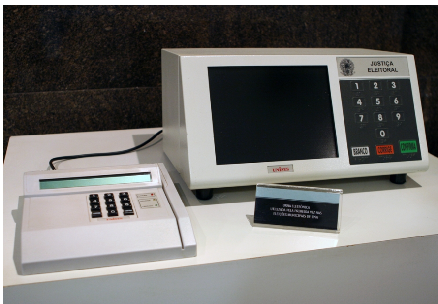
Figura 1. Urna Eletrônica utilizada no Brasil em 1996, do tipo DRE
