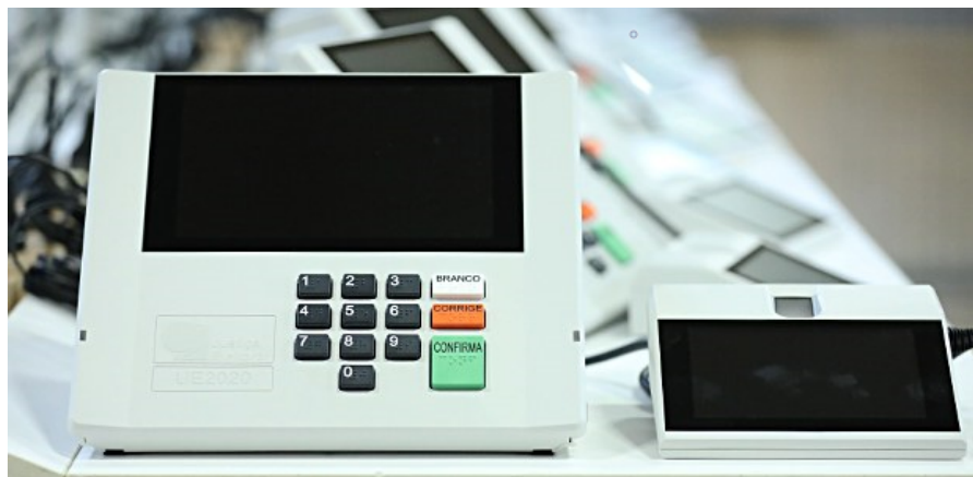
Figura 2. Urna Eletrônica utilizada no Brasil, a partir de 2022, do tipo DRE
