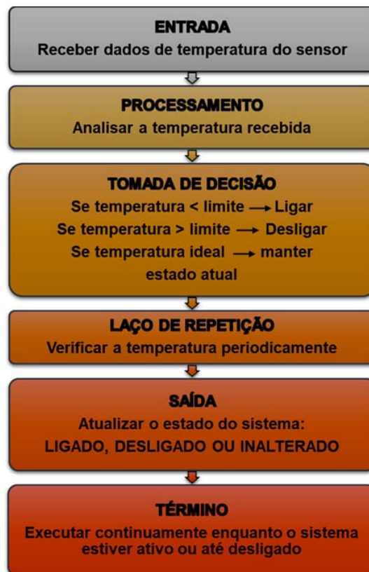
Figura 1. Fluxo de funcionamento de um algoritmo de controle de temperatura em sistemas de aquecimento residencial.
