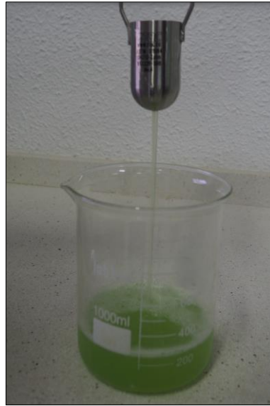
Figura 6. Proceso del registro de viscosidad del mucílago o goma (Autora: O. Medina, 2019).
