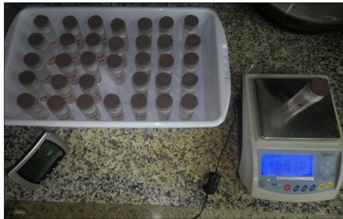
Figura 7. Ensayo para el estudio de permeabilidad al vapor de agua de las probetas (Autora: O. Medina, 2019).
