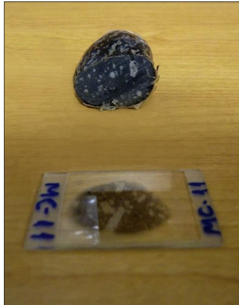
Figura 12. Aspecto de seixo de diabásio porfirítico arredondado com a lâmina delgada em primeiro plano. Fotografia: Renato Ramos (2012).
