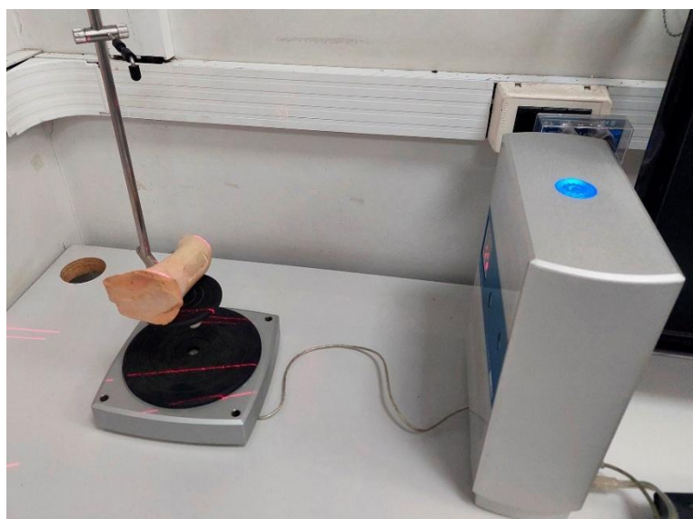
Figura 4. Processo de escaneamento de um fragmento de alça com o NextEngine 3D Scanner Ultra HD. Fotografia: Matheus Moraes Cruz.
